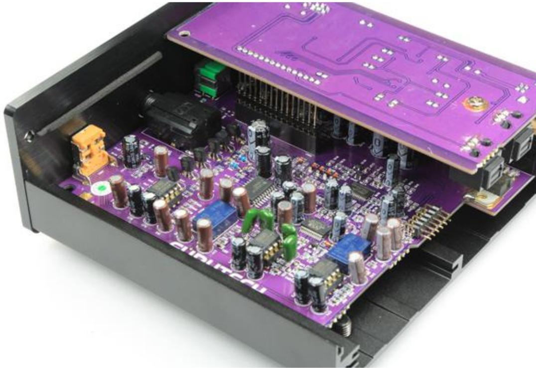
耳機放大當然也是 **Esprit** 的重點。**Esprit** 增強了對於高阻抗耳機的驅動能力，它大辣辣地直接在面板上標示可以驅動 16 歐姆至 600 歐姆的耳機，性能十分強悍。**Esprit** 的背板上還有一組 RCA 類比輸出端子，它也具備前級輸出功能，使用時經由面板的旋鈕調整音量。
