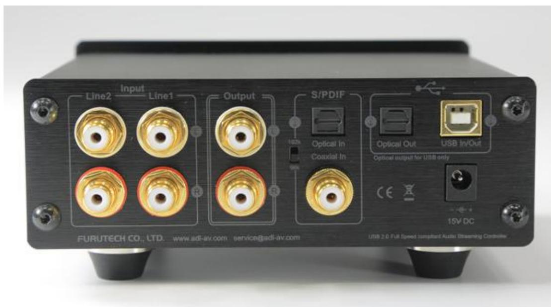
Esprit 內建 Cirrus Logic CS5361 類比轉數位晶片，能支援 24bit / 192kHz 轉換，但因為 USB 控制晶片 Tenor TE7022L 只有 24bit / 96kHz 取樣率，因此 Esprit 僅支援 32/44.1/88.2/96 kHz 的錄音。不過這並未減損 Esprit 的好用程度，因為 Esprit 還提供了錄音輸出的衰減功能，透過面板的切換開關，讓用家可選擇 0、6、12 dB 共三種衰減值，以免錄得過大而失真。此外，錄音時 Esprit 輸出的 S/PDIF 訊號可支援像是 AC3 或 DTS 的多聲道格式。Esprit 並未提供錄音軟體，不過沒關係，它給了一個免費錄音軟體的連結 <http://audacity.sourceforge.net/>，總之一切都替你準備好了。
